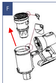
F Бөлшектелген түрдегі циклон тобы
